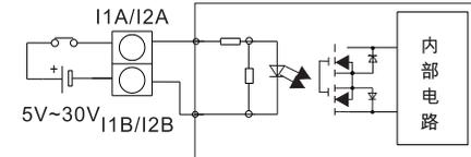
信号输出电路连接示意图
